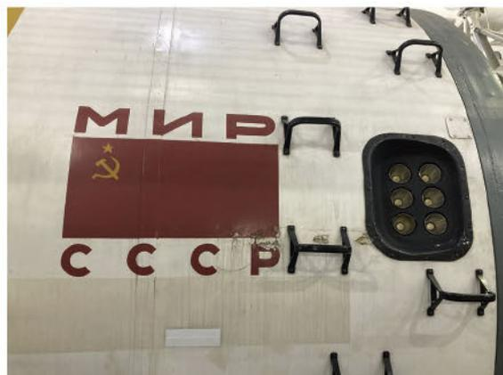
写真13 展示外装。一部塗装の剥がれや雨垂れの跡が見られる。
