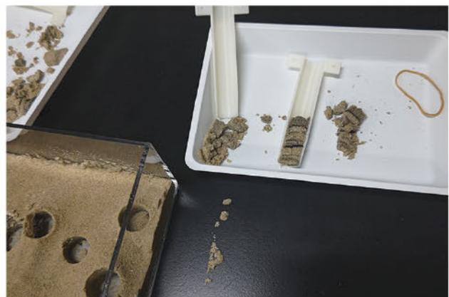
写真11：砂箱からのコア掘削の様子
