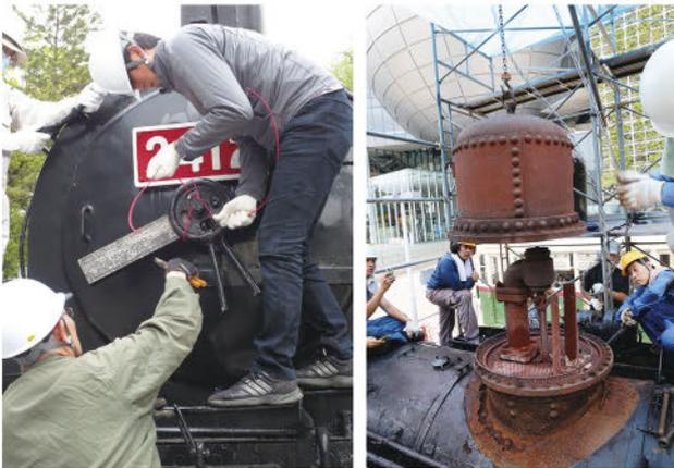
写真3 煙室開放(左) 蒸気ドーム内調査(右)
