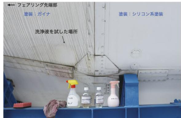
写真5 洗浄液による汚れの除去試験
