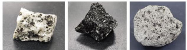
写真1：花崗岩 写真2：松脂岩 写真3：軽石
