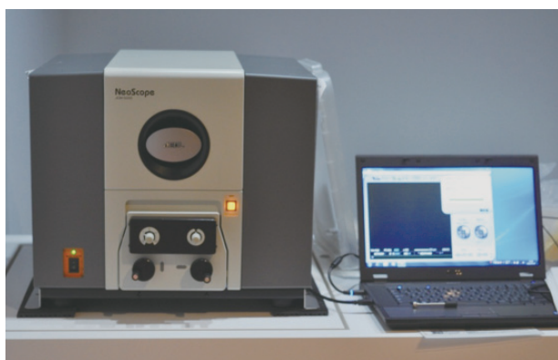
写真1 生命ラボの走査型電子顕微鏡：卓上型 SEM (JCM-5000, 日本電子株式会社)
