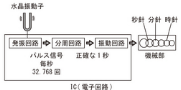
図2 クォーツ時計のしくみ
