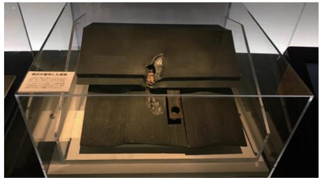
図10 隕石が衝突した屋根
