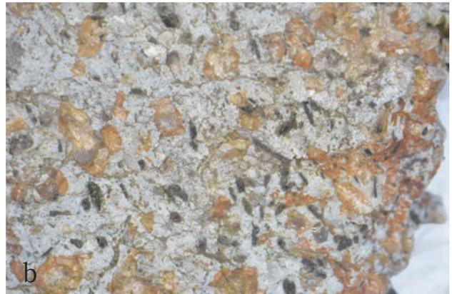
写真3 香川県高松市由良山で採取された「由良石」との比較。（a=由良石、b=名古屋市役所本庁舎外壁の剥離片）
