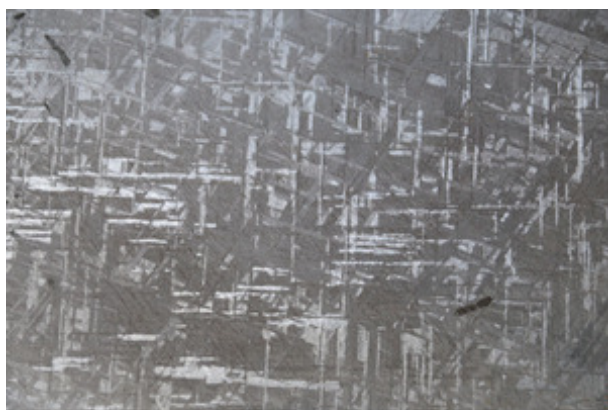
ギベオン隕石のウィッドマンシュテッテン構造
