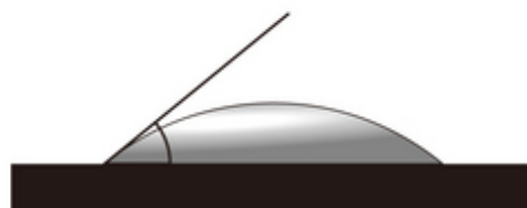
図2 親水性(接触角が小さい)
