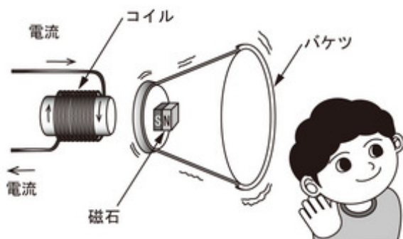
図 電流をコイルに流すとバケツが振動する
